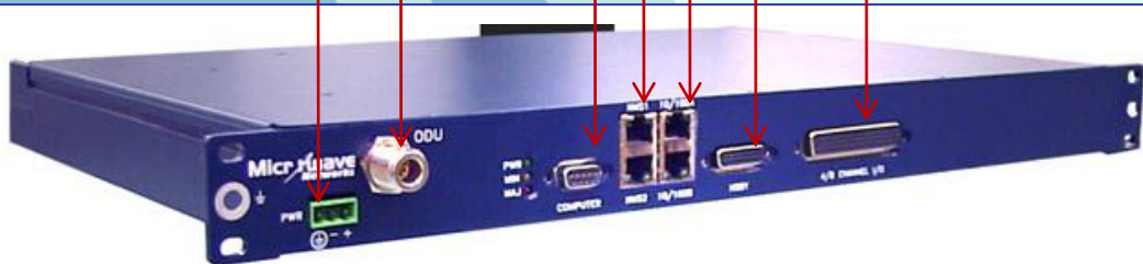
Интерфейсный модуль режима 1+0 (высота 1U)
